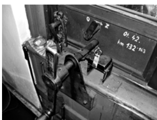
Obr. č. 1: Příklad uzamykání závor v uzavřené poloze
