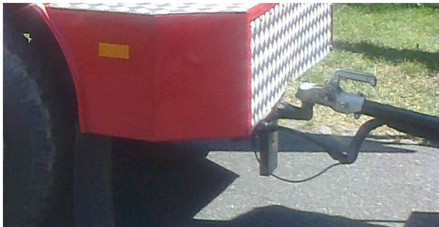
Obr. 1: první vagoněk soupravy s dvěma přípojnými vozidly není brzděný, spojovací zařízení ISO50 je zcela nevhodné z důvodu vyšší přípojně hmotnosti, šikmé montáže, chybí dodatečná 3. pojistka a pojistné spojení vozidel.
