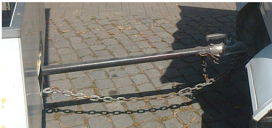
Obr. 2: první vagoněk soupravy s dvěma přípojnými vozidly není brzděný, spojovací zařízení ISO50 je zcela nevhodné z důvodu vyšší přípojně hmotnosti, šikmé montáže, chybějící dodatečné 3. pojistky a provedení pojistného spojení vozidel je nevhodné.
