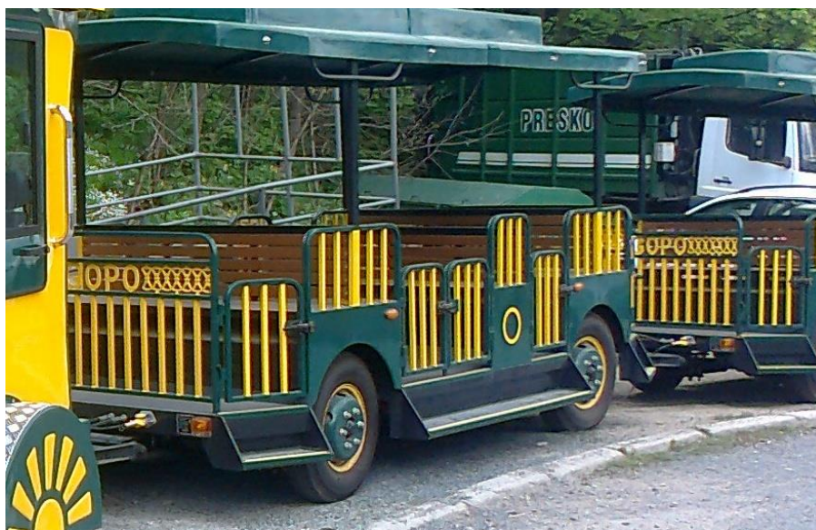
Obr. 5: boční ochrana proti vypadnutí je konstruována robustně, bohužel výška boční zábrany (dveří) je nedostatečná a chybí signalizace otevření směrem k řidiči.
