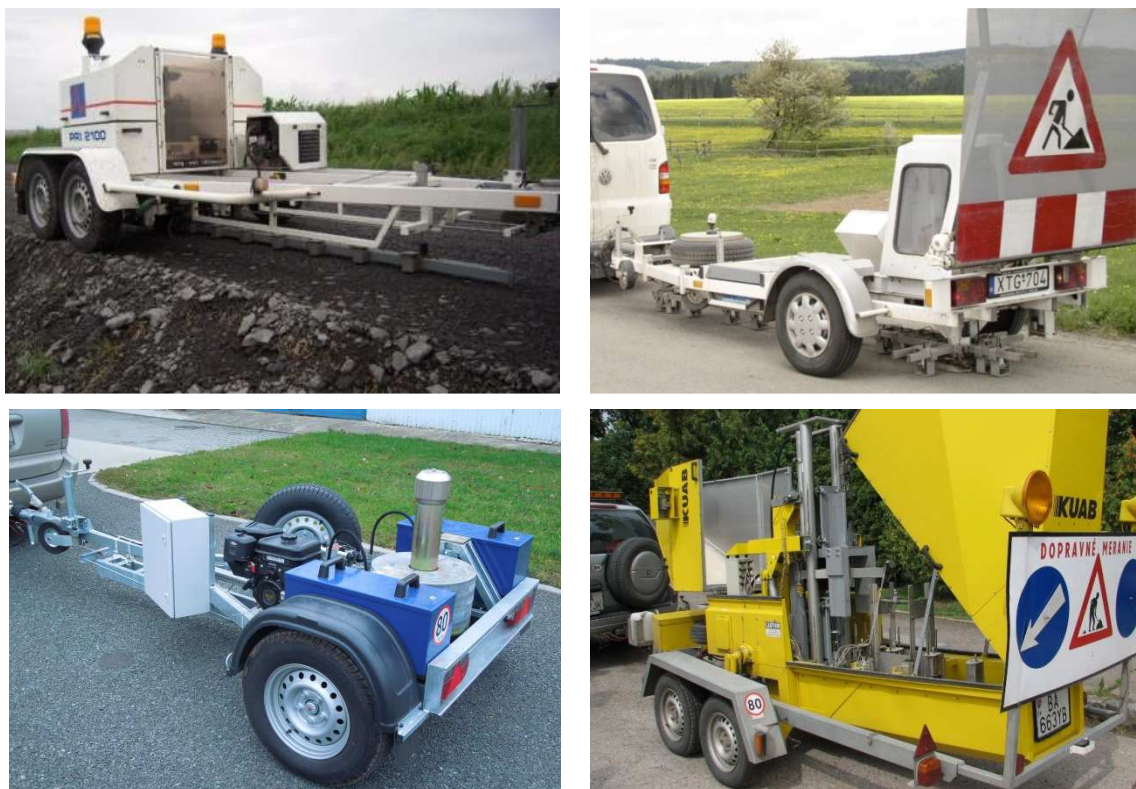
Obr. 2: Ukázky rázových zařízení FWD – Carl Bro (vlevo nahoře), Dynatest (vpravo nahoře), Rodos (vlevo dole), Kuab (vpravo dole)
