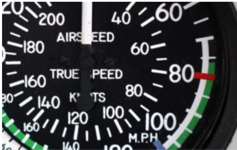
Rychlosti V_{YSE} a V_{MC} u dvoumotorového letounu
