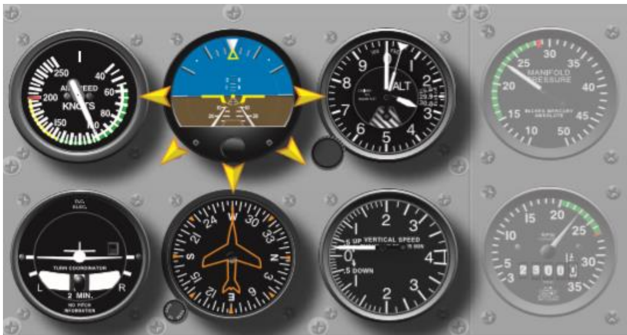
Schéma radiálního skenu analogového panelu
