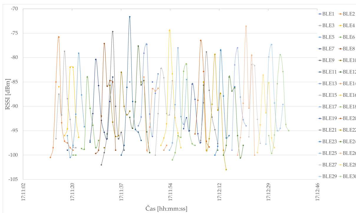
Obr. 7 Naměřené hodnoty RSSI při průjezdu tunelem
