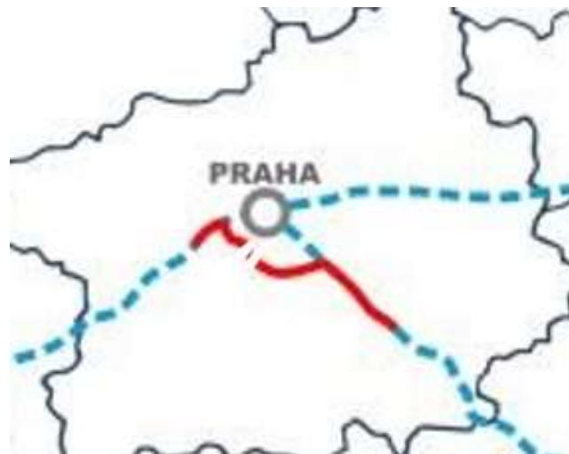
Obr. 4 Komunikace v první etapě projektu C-ROADS (C-ITS pilot). Červeně úseky s podporou ITS-G5, kde přerušená místa označují tunely Cholupice a Lochovo na D0, které musely být z pilotu vyjmuty kvůli absenci systému lokalizace
