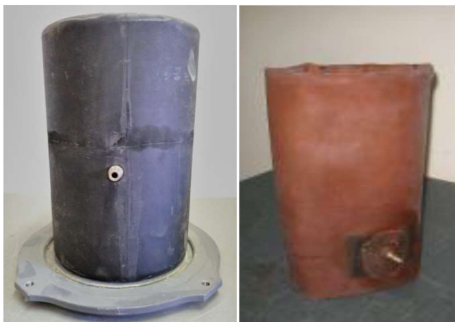
Obrázek 7: Pryžová a latexová buňka opatřená vzduchovým ventilem
