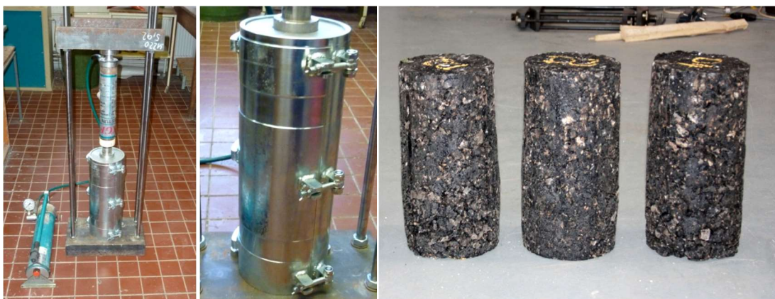
Obrázek 8: Zhutňovací set / silnostěnná rozevratelná ocelová forma / zkušební vzorky
