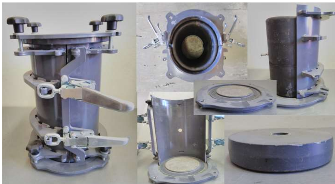
Obrázek 6: Ocelová triaxiální zkušební forma
