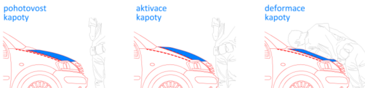
obr. 4. Prvek pasivní bezpečnosti – aktivní kapota
