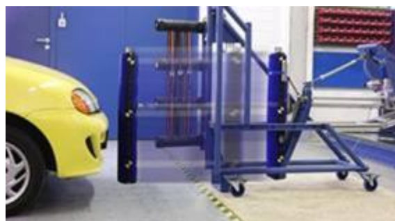
obr. 66. Test nárazu impaktoru – dolní končetiny
